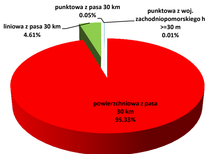
Rysunek 18 Udział poszczególnych typów emisji w bilansie emisji napływowej B(a)P dla strefy zachodniopomorskiej w 2011 r.
